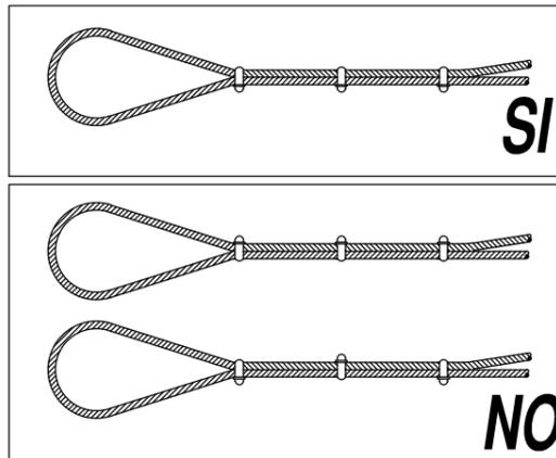
COLOCACIÓN DE GRAPAS EN LAS GAZAS (Metodo de instalación de las grapas)
