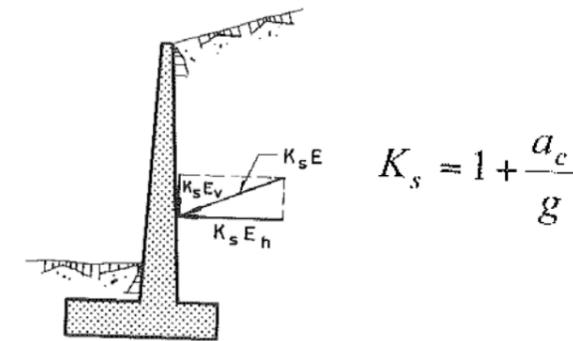
La aceleración sísmica de cálculo,  $a_c$ , se define según el apartado 2.2. de la norma sismorresistente NCSE-02 como:
