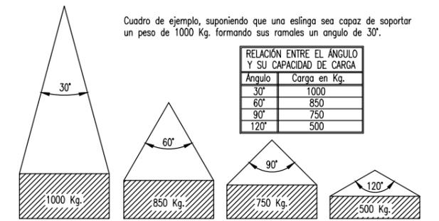
La carga máxima que puede soportar una eslinga depende, fundamentalmente, del ángulo formado por los ramales de la misma. A mayor ángulo, menor será la capacidad de carga de la eslinga.
