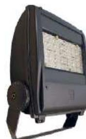
La armadura está formada por dos piezas, el cuerpo y el marco, de aleación de aluminio inyectado a presión. Ambas partes cierran una sobre otra mediante un sistema de dos charnelas situadas en la parte posterior del proyector, asegurando la perfecta hermeticidad (IP 66) con un cierre rápido de aleación de aluminio del mismo tipo que la armadura que está situado en la parte frontal y que permite la apertura del aparato sin utilizar herramientas.
